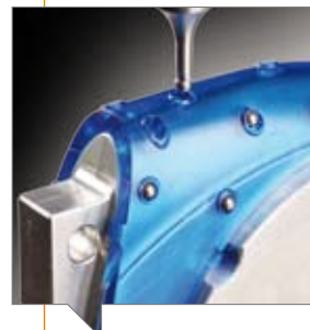
Zwischenmontage mit der Präzisionsverpressung von Edelstahlkugeln in das Halbfertigteil. Im nächsten Step erfolgt die Umspritzung der Kugeln.
